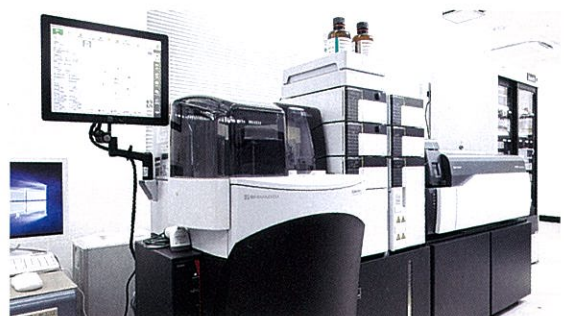
崔教授の研究室にある島津製作所の検体前処理装置CLAM-2000 CLと液体クロマトグラフ質量分析システムNexera LC-MS/MSシステム(LCMS-8050CL)。海外では研究用途だけでなく臨床現場にも質量分析計の導入が積極的に進められており、日本でも導入の可能性が広がっている。
